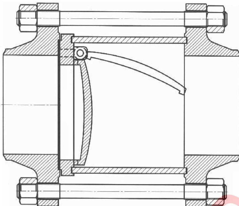
Установочное положение клапана: на горизонтальном трубопроводе изделие устанавливается отметкой «ВЕРХ» в верхнее положение, движение рабочей среды по стрелке. На наклонном трубопроводе – входным патрубком вниз, направление потока по стрелке «снизу – вверх», отметка «ВЕРХ» в верхнее положение. На вертикальном трубопроводе – входным патрубком вниз, направление потока по стрелке «снизу – вверх».
