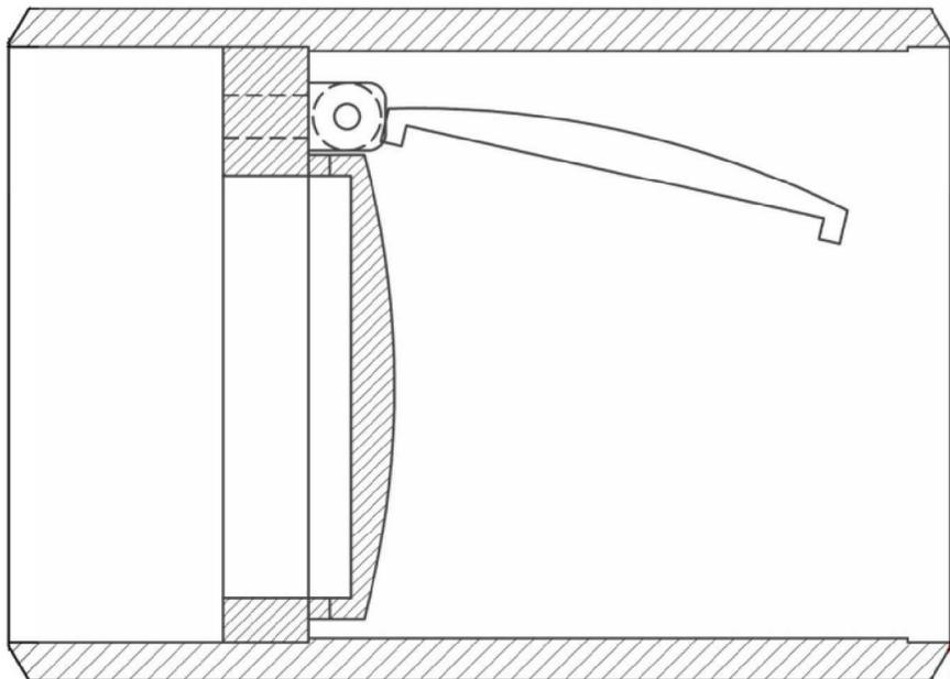
Установочное положение клапана: на горизонтальном трубопроводе изделие устанавливается отметкой «ВЕРХ» в верхнее положение, движение рабочей среды по стрелке. На наклонном трубопроводе – входным патрубком вниз, направление потока по стрелке «снизу – вверх», отметка «ВЕРХ» в верхнее положение. На вертикальном трубопроводе – входным патрубком вниз, направление потока по стрелку «снизу – вверх».
